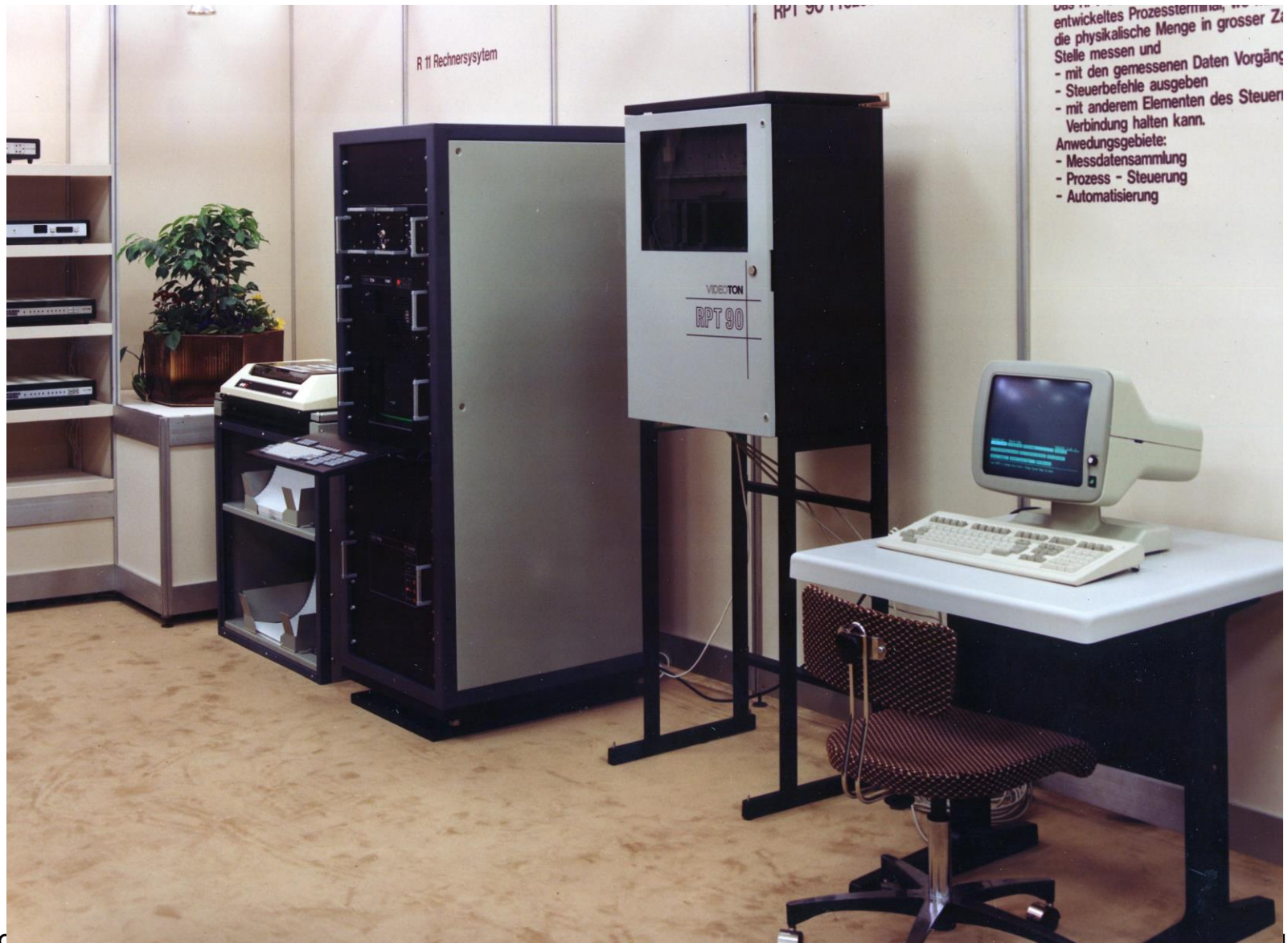
R11R és RPT 90 folyamatirányító terminál
