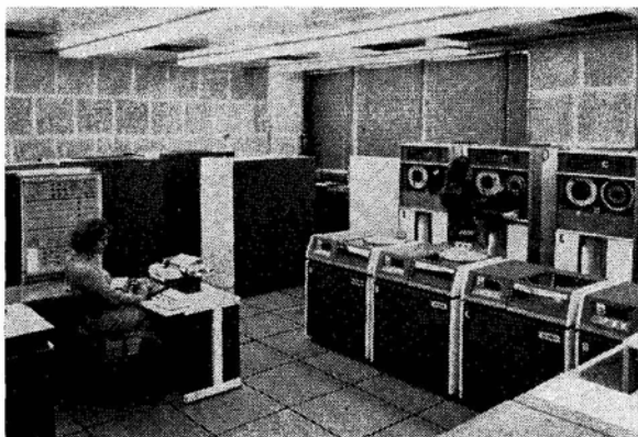
1. ábra. Közepes teljesítményű szovjet ESZR számítógép, mely a TAF rendszer központi gépeként (host) alkalmazható
