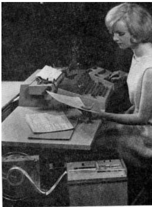
2. Siemens 282-es elzárolóautomata
